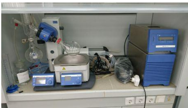
Модернизированный роторный испаритель RV 10 control V auto с автоматической системой управления и прямым подключением к вакуумному наосу, укомплектованный криостатом
