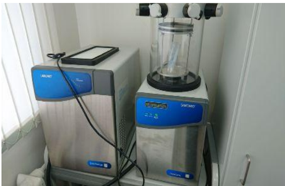
Настольная центрифуга с охлаждением; универсальная настольная лиофильная сушилка для сушки получаемых лабораторных образцов
