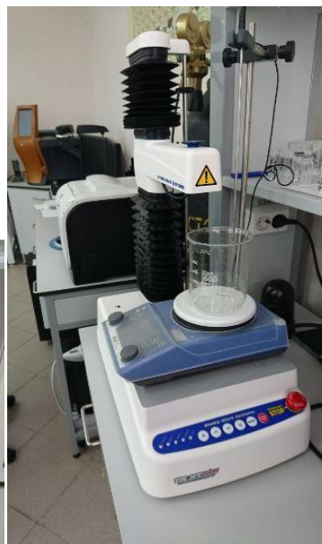
Анализатор текстуры, оснащенный необходимыми типами зондов и насадок для изучения процессов адгезии и механической прочности
